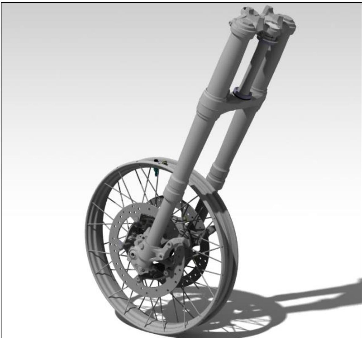
Abbildung 3: ZSB-Vorderradführung der K81
