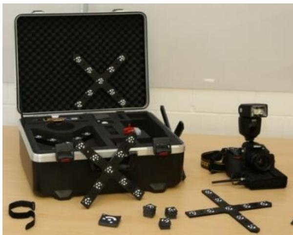
Abbildung 7: Messsystem der GOM GmbH (4)
