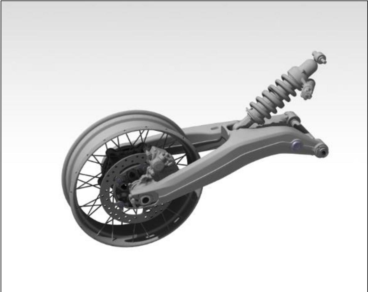
Abbildung 5: ZSB-Hinterradführung der K81
