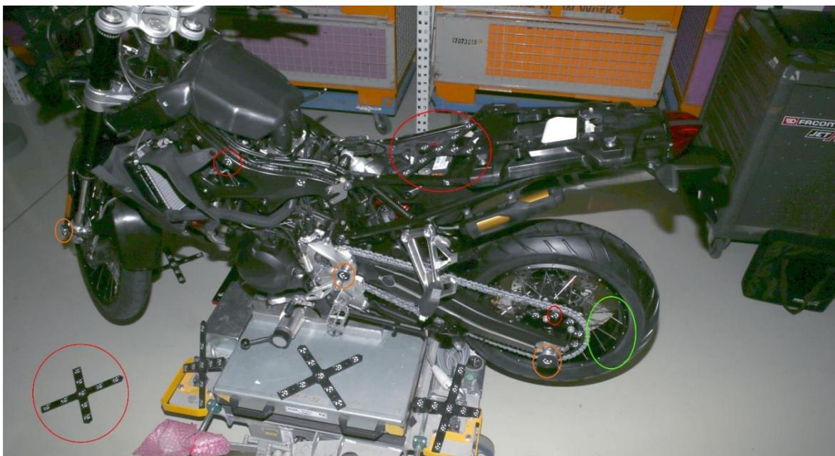
Abbildung 30: Messaufbau der Fahrgeometrievermessung
