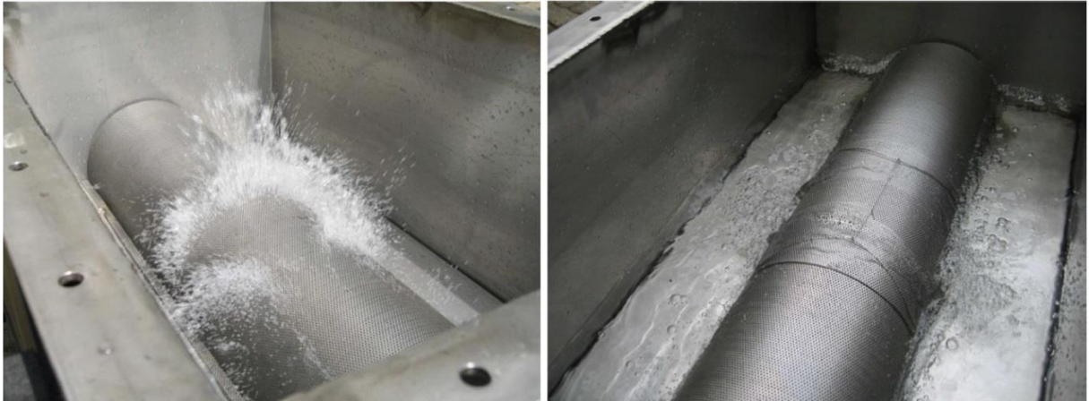
Abbildung 3.3: Vorversuche für ein gleichmäßiges Strömungsprofil mit Prallblechen [2]
