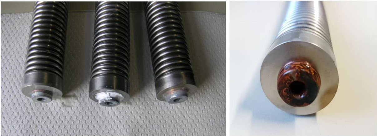
Abbildung 3.8: (links) Versiegelung des Kupferdichtrings, (rechts) korrodierter Schraubenkopf
