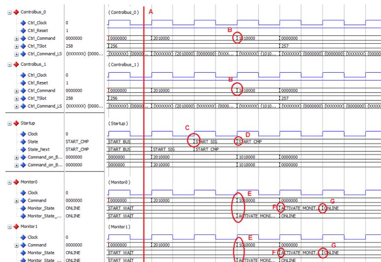
Abbildung 7.13: Simulationsergebnis des Systemstarts. Betrachtung der redundanten Steuerbusse und Monitore.
