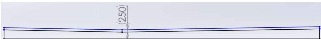
Abbildung 3. 1: Wasserstand auf dem Schwimmdach nach DIN EN 14015
