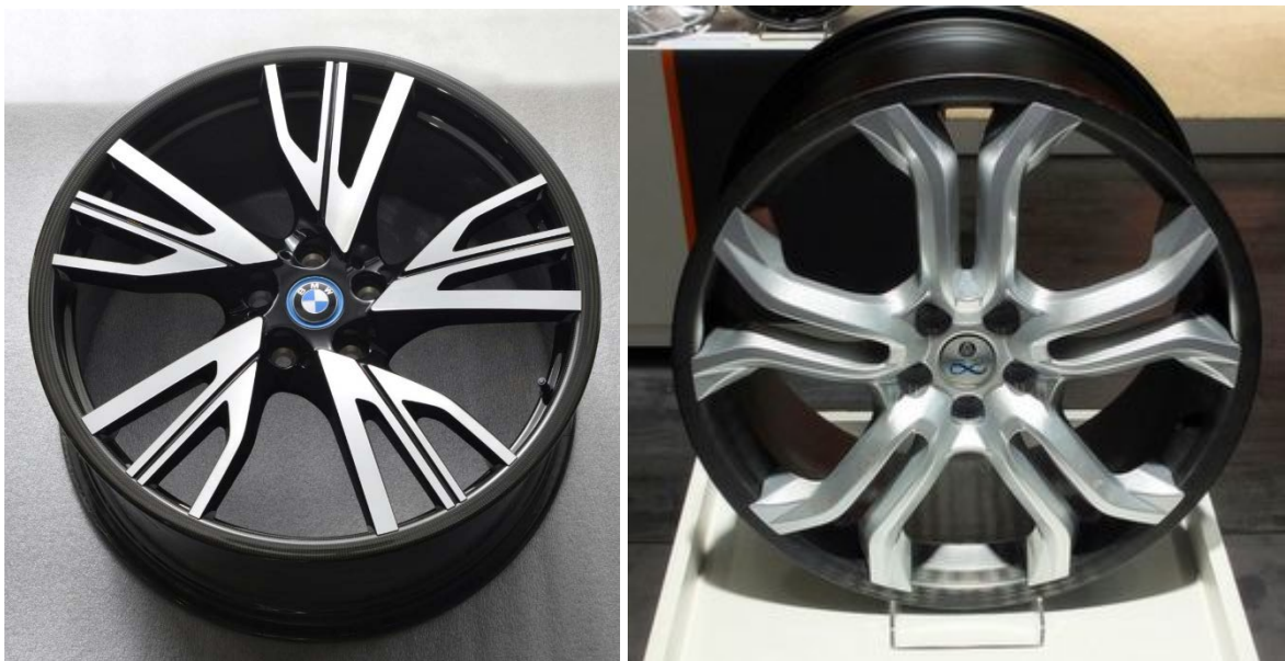
Abbildung 3.9: MMD-Räder aus CFK-Aluminium, Hersteller links: BMW [33], rechts: ThyssenKrupp und Maxion in Zusammenarbeit [34]
