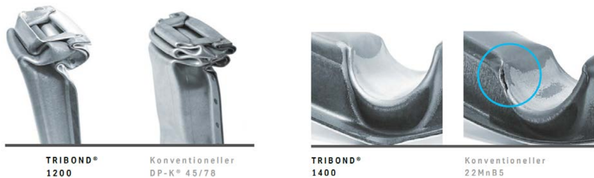
Abbildung 3.26: Deformationsverhalten von Tribond 1200 und Tribond 1400 im Vergleich zu bisher eingesetzten konventionellen Stählen [46]
