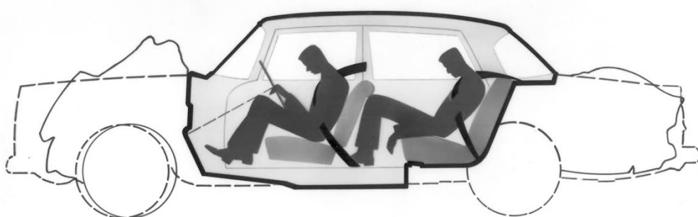
Abbildung 2.2: Passive Sicherheit nach Béla Barényi - steife Fahrgastzelle und verformbare Knautschzonen
