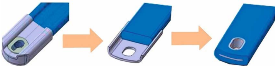
Abbildung 3.12: Entwicklung des Energieabsorptionselements an der Strebe [34]
