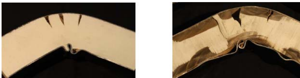
Abbildung 3.16: Deformationsverhalten in Abhängigkeit des Trägermaterials, Trägermaterial links: DC04, rechts: V2A [38]
