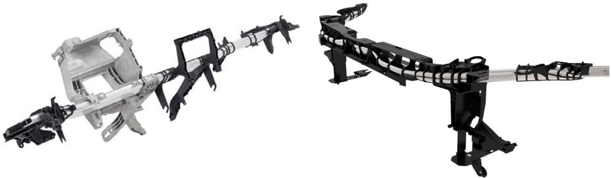
Abbildung 3.8: links: Cockpitträger, rechts: Frontendträger aus Aluminium mit kohlefaserverstärkter Polyamidverstärkung [31]
