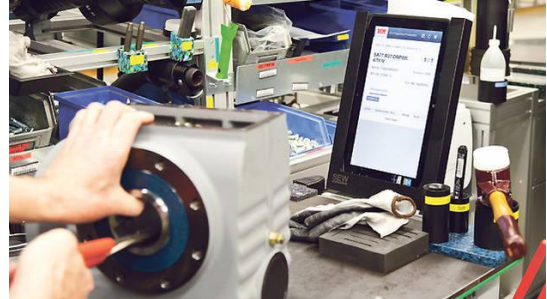
Abb. 31: Mobiler Montageassistent zur Visualisierung aller Auftragsinformationen
