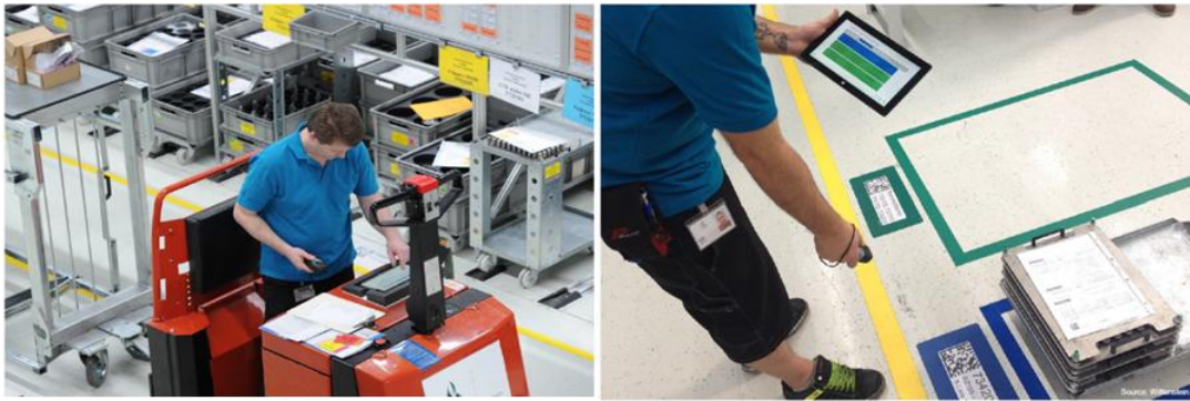
Abb. 23: Einsatzmöglichkeiten von Tablet-Computer und Pocket-Scanner im Rahmen eines Milkruns
