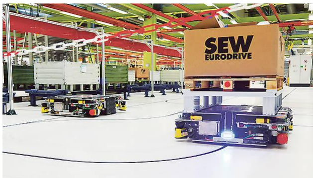
Abb. 32: Logistik-Kapsel für den Transport von Zwischenprodukten und Material zu U-Zellen
