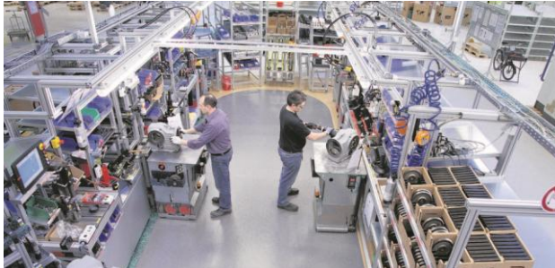
Abb. 30: Bsp. für Einsatz eines mobilen Montageassistenten in U-Zelle
