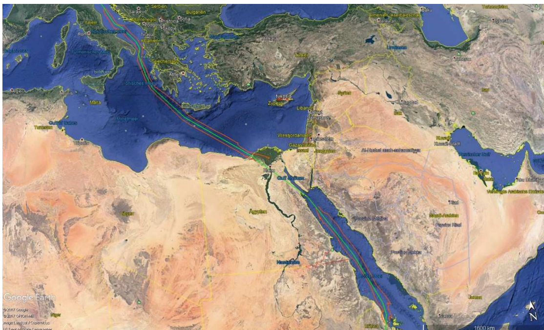
Abbildung 32: Globale Ansicht der Überschall-Flugtrajektorie LHR - NBO und dem Knallteppich der aus der Atmosphäre vom 2014-01-01-00 berechnet wurde
