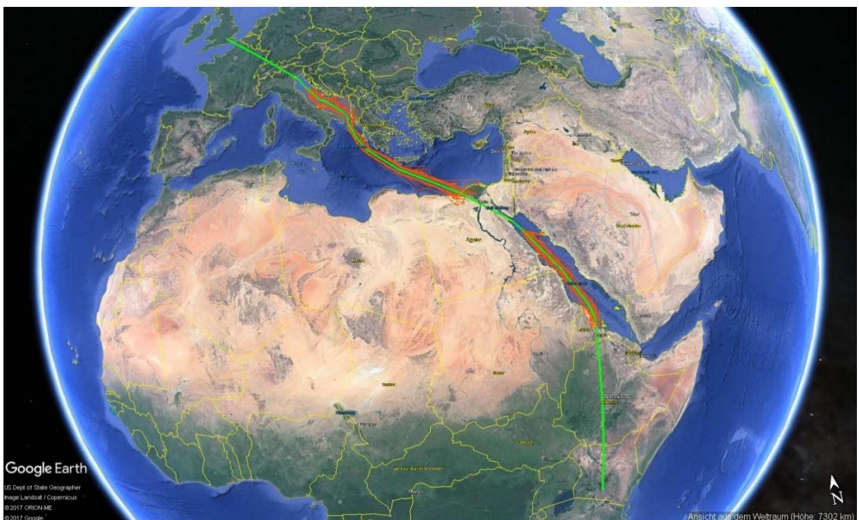
Abbildung 33: Globale Ansicht der Überschall-Flugtrajektorie LHR - NBO und den aus den 12 Atmosphären resultierenden Knallteppichen
