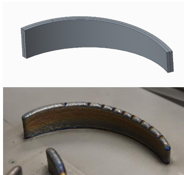
Abbildung 5-3: Oben - CAD-Modell der geschweißten Kontur, Unten - Ergebnis der Schweißung
