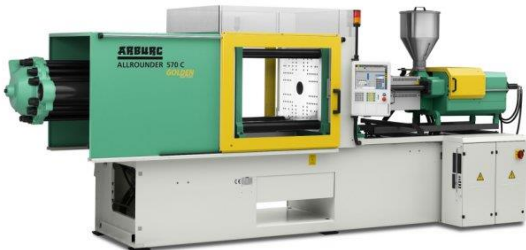
Abbildung 1: Spritzgießmaschine ALLROUNDER von ARBURG [1]
