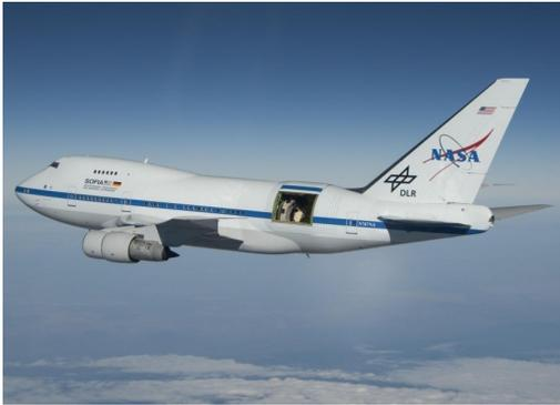
Abbildung 3.3.: SOFIA Forschungsflugzeug m. eingebautem Teleskop unter Verwendung v. CANas, [11]
