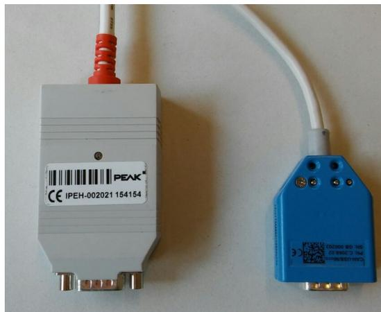
Abbildung 4.3.: USB/CAN-Brücken zur Kommunikation zwischen BCU und PC: IPEH-002021 von PEAK(links) und CAN-USB/Micro von ESD (rechts)
