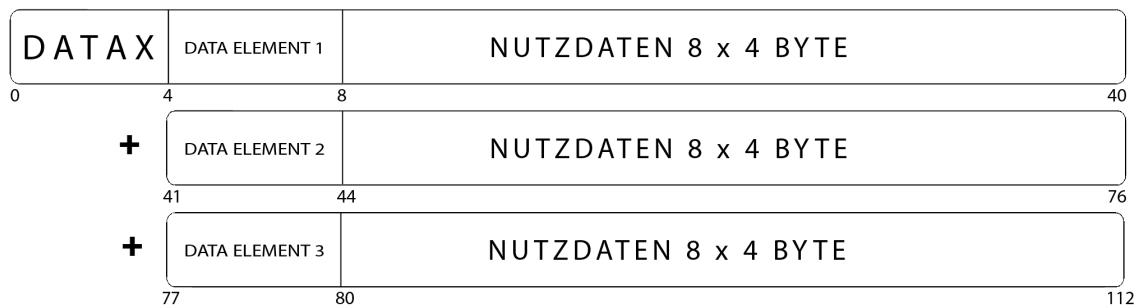
Abbildung 3.8.: Paket für mehrere Data Elements
