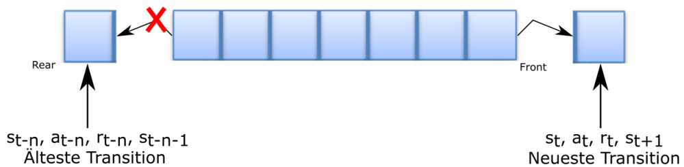
Abbildung 3.24.: Hinzufügen einer neuen Transition bei vollem Buffer (Eigene Erstellung)
