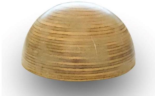
Abbildung 25: Formwerkzeug aus Holz
