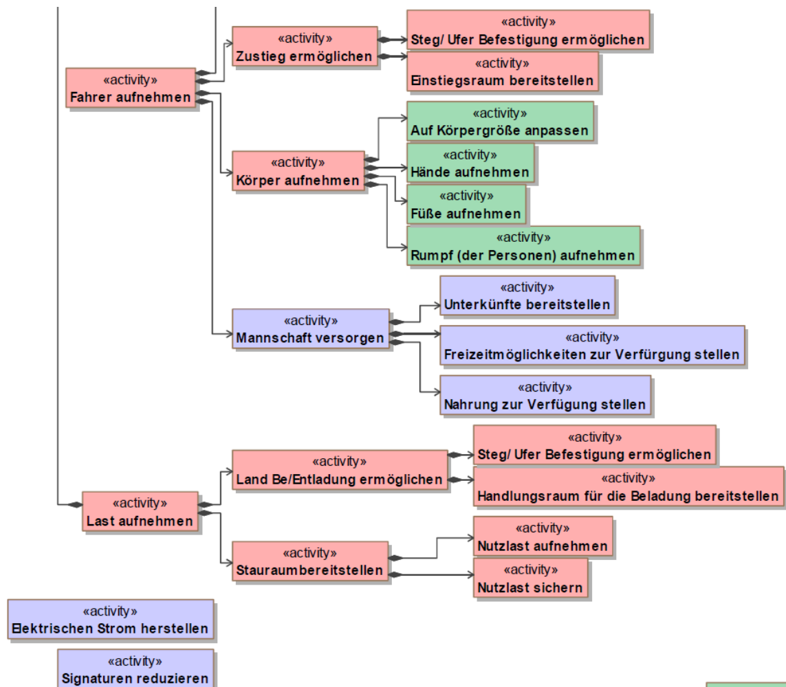
Abbildung 35: Ausschnitt Übertragung der funktionalen Architektur des Regatta-Tretbootes auf das PS
