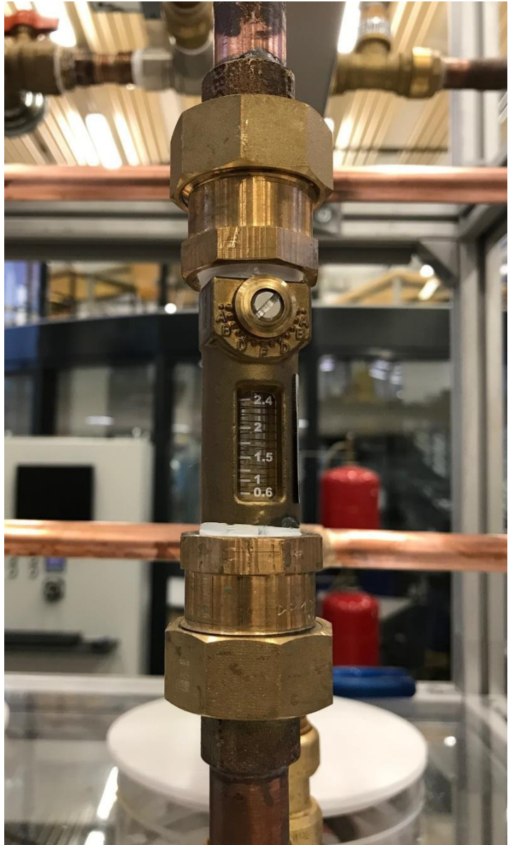
Abbildung 17: Lötfitting mit Tacosetter
