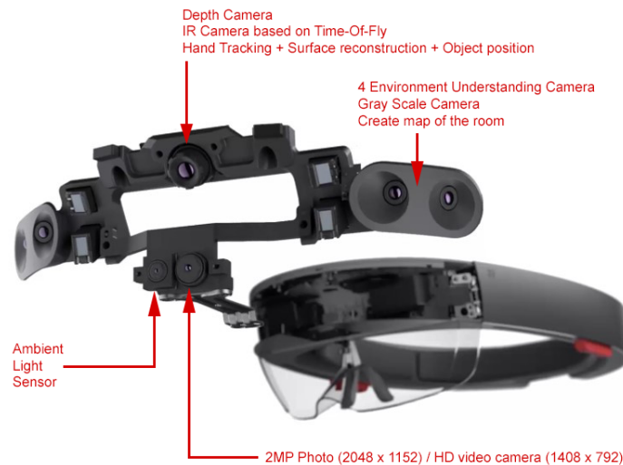
Abbildung 2.17: Die Sensoren der HoloLens
