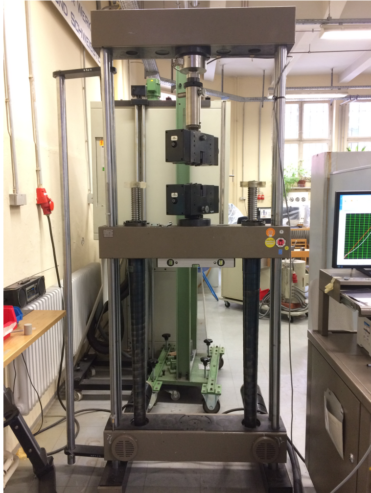
Abbildung C.2.: Universal Zugtestmaschine im Materialkudelabor am Institut für Werkstoffkunde und Schweißtechnik der HAW Hamburg.
