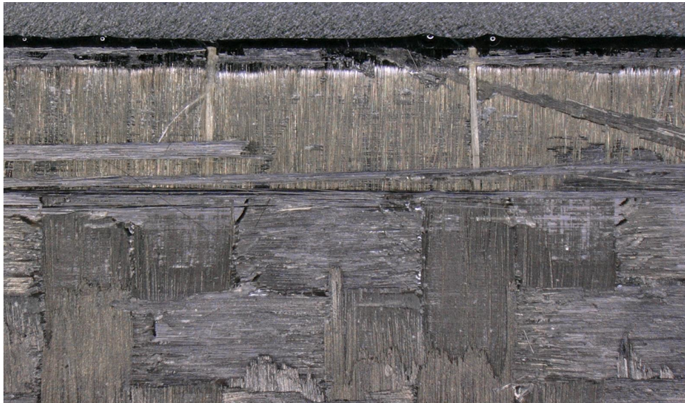
Abbildung C.1.: Teilweiser Delaminierbruch einer Zugscherprobe. Die oberste Verstärkungsfaserlage mit dem Körpergewebe ist teilweise herausgebrochen und hat das darunterliegende unidirektionale Gewebe freigelegt. Dabei kamen Schussfäden (weiß) zum Vorschein, der Faserbündel des Faserhalbzeuges vor der Aushärtung des Laminates in Position hält. Dieser Bruch war unter den Versuchen im Rahmen dieser Arbeit einzigartig.
