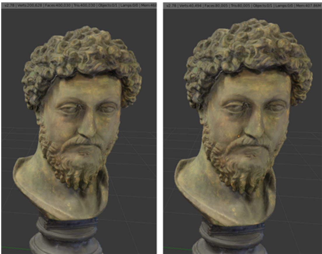
Abbildung 4.3: Beispiel vom Simplifizieren. Links vor, Rechts nach dem Anwenden eines 0,2 Decimate Modifiers in Blender. Eine Reduzierung von 200.000 Vertices auf 40.000
