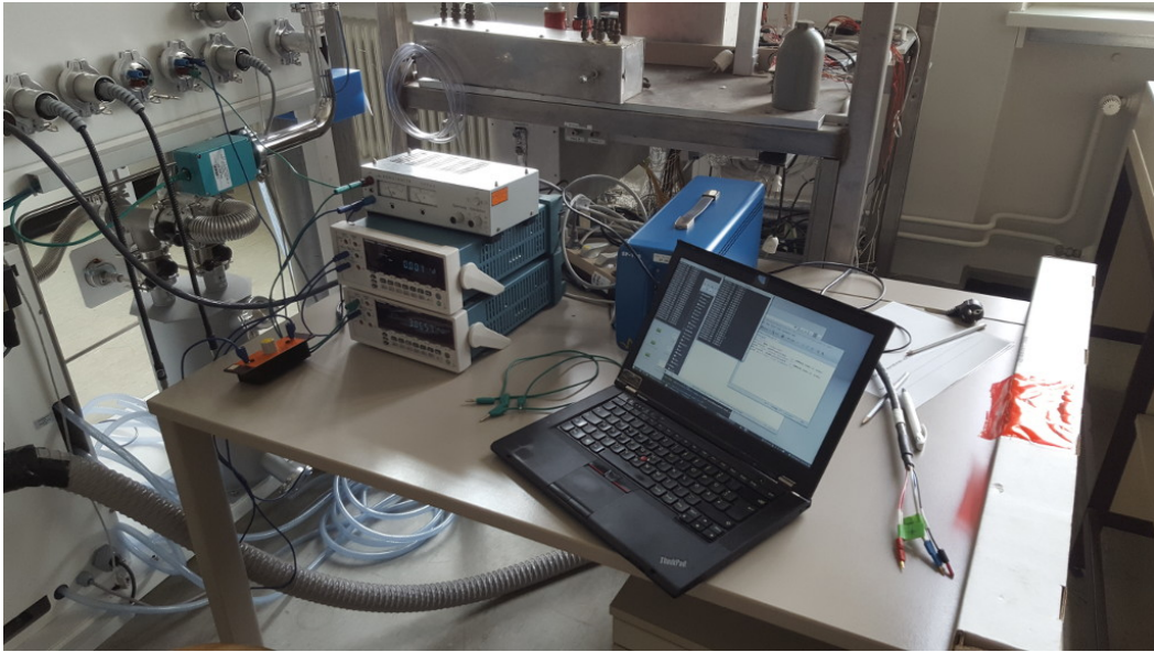
Abbildung 3.12.: Steuersystem des Faseraufbaus; zu sehen ist der verwendete Widerstand, Spannungsquelle, Multimeter und Amperemeter; auf dem Laptop wird die Steuersoftware gestartet.
