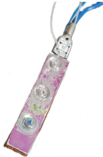
Abbildung 3.11.: Zu sehen ist der Faseraufbau. An der Beugung der Faser ist das ITO-Gemisch aufgebracht. Über das Aluminiumblech wird der Strom abgeleitet. Dahinter wird Lithium-Metall als Anode beigefügt.
