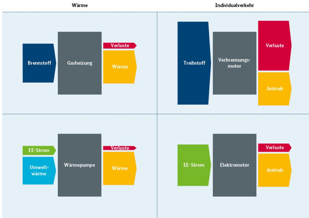
Abbildung 4-15 Beispiel Wärmepumpen und Elektromobilität<sup>56</sup>
