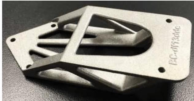
Abbildung 10: Durch die Blockchain verifiziertes, additiv gefertigtes Titanteil mit eingebetteter Teilenummer
