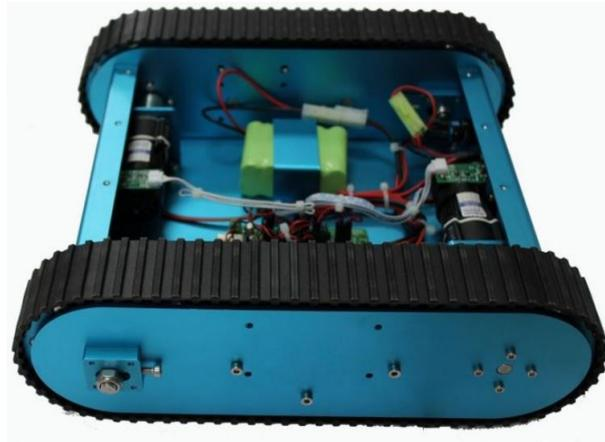
Abbildung 2.3.: Mobile Roboterplattform [ROB17]
