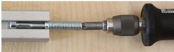
Abbildung 4.2.: Einsetzen der T-Matik Gewinde mit T25 Torx
