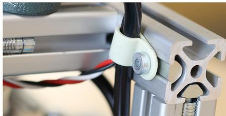
Abbildung 4.6.: Kabelführung
