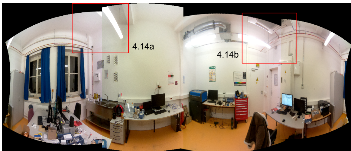
Abbildung 4.13.: Stitching von vier Kameras zu einem sphärischen Panorama mit dem entwickelten Algorithmus (Markierte Fehler in Abbildung 4.14)
