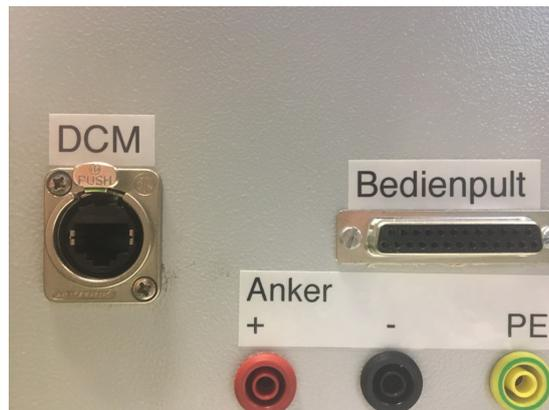
Abbildung 2.4: Seitenansicht Schaltschrank mit Ethernet-Kupplung
