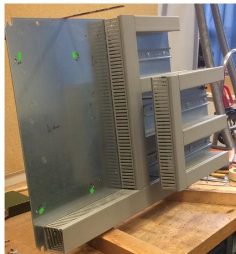
Abbildung 2.7: Fertig gestellte Grundplatte
