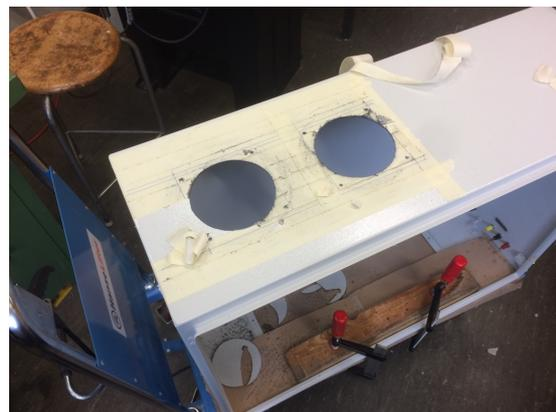
Abbildung 2.9: Einbringung Lüfterausschnitte
