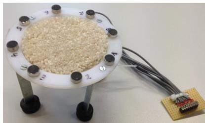
Abbildung 3.4: Mikrofonarray mit Anschlussstecker
