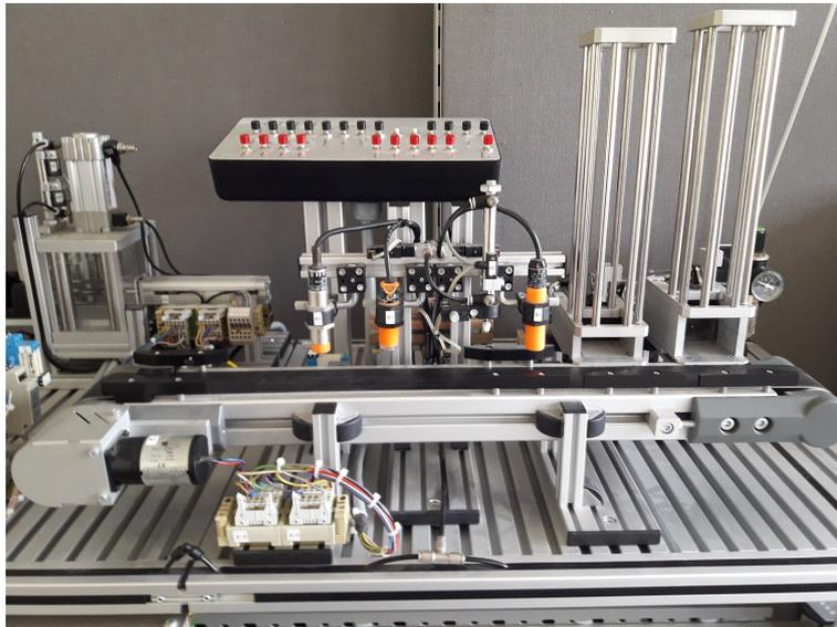
Abbildung 3.3: Magazin und Förderband mit Sensoreinheit
