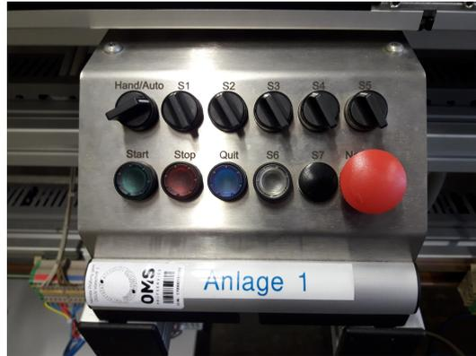
Abbildung 3.4: Bedieneinheit der Modellanlage
