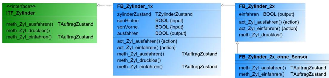
Abbildung 6.6: Klassen der Pneumatikzylinder
