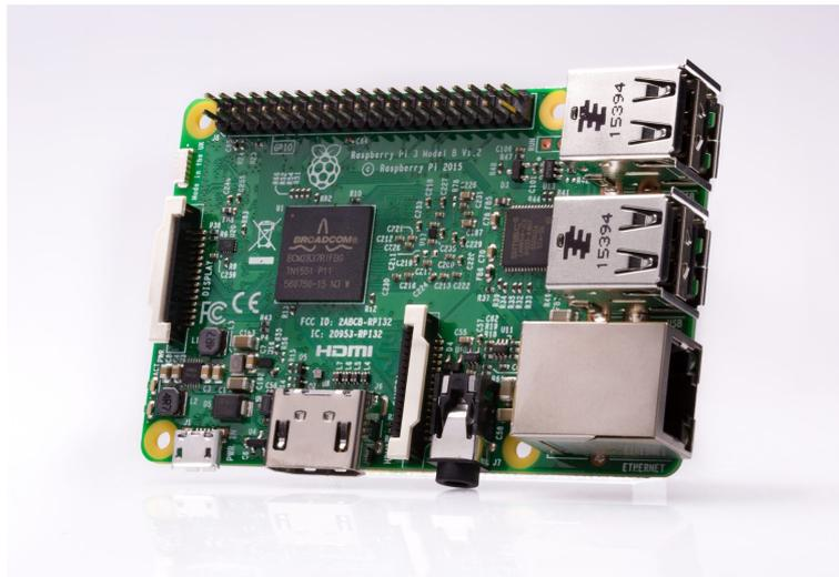
Abbildung 2.2: Raspberry Pi 3 Model B [10]
