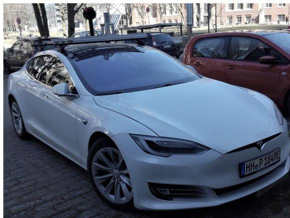
Abbildung 3.1.: Vorhandener Versuchsaufbau mit Tesla Model S und den installierten Sensorsystemen auf dem Dachträger
