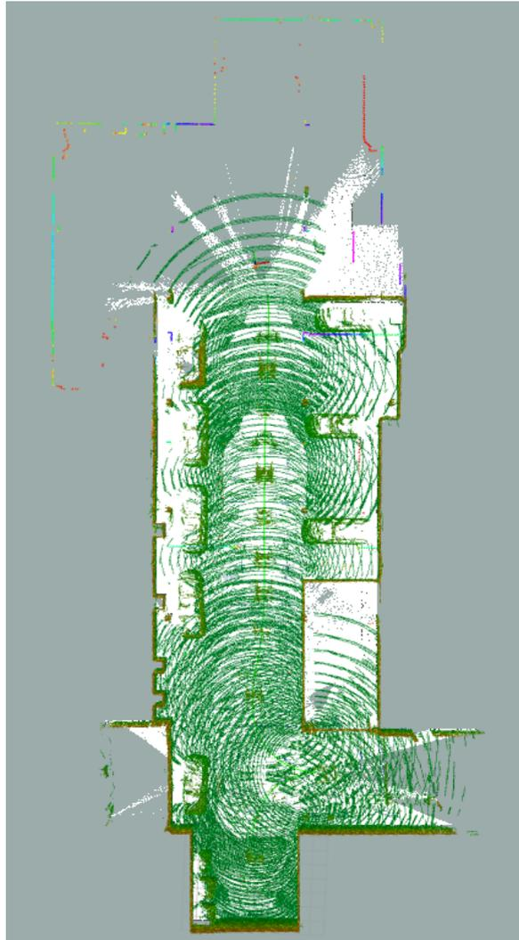
Abbildung 7.19.: Erzeugte dreidimensionale OctoMap-Karte mit der Ansicht von oben auf die Teststrecke
