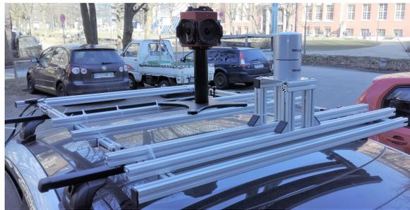
Abbildung 3.2.: Ansicht des montierten Dachträgers mit dem Velodyne HDL-32 (vorne) und dem Ladybug 5+ dahinter
