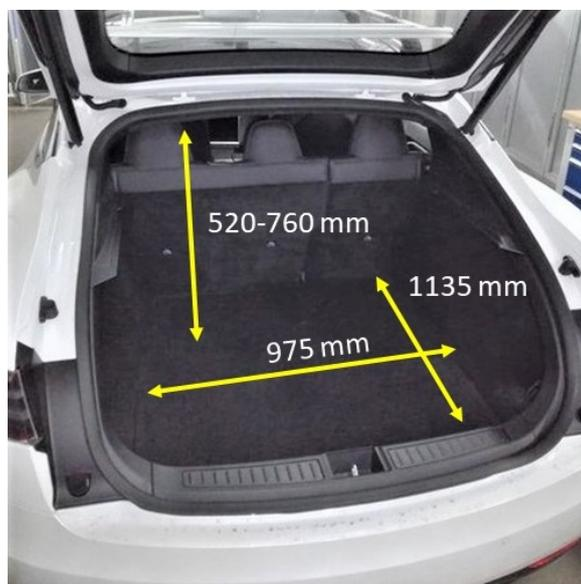
Abbildung 3.7.: Kofferraum des Tesla Model S
