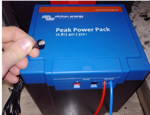
Abbildung 3.4.: Peak Power Pack 40 Ah mit Drucktaster
