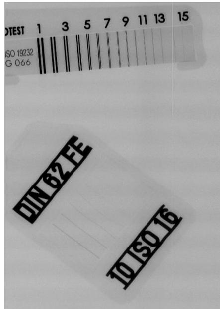
Abbildung 5.1: Röntgenaufnahme bei Prüfszenario D mit  $v_{\text{TDI-Kamera}} = 11,12 \text{ cm/min}$
