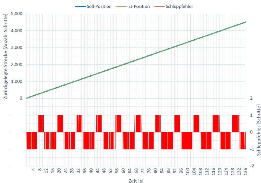
Abbildung 5.7: Fahrverhalten des Motors mit  $n_{\text{Motor}} = 5 \text{ U/min}$  in horizontaler Lage
