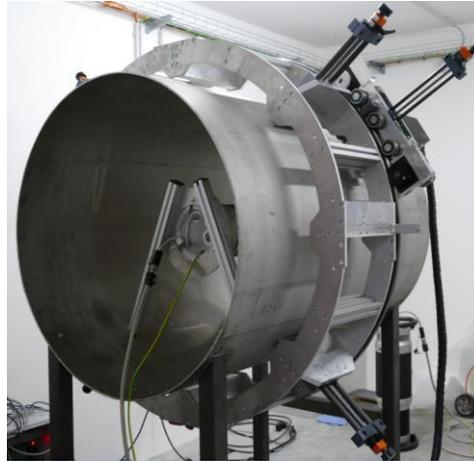
**Abbildung 4.2: Aufgebautes Röntgensystem in der Strahlenschutzkabine**
