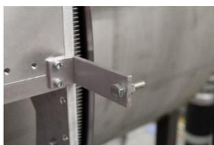
**Abbildung 4.23: Metallschraube als Referenzposition**
