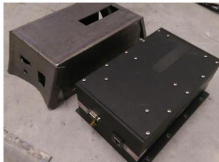
**Abbildung 3.25: Bleiummantelung der TDI-Kamera**
