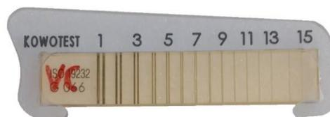
**Abbildung 3.2: Fotoaufnahme des Doppeldraht-BPKs für den Teststand**
