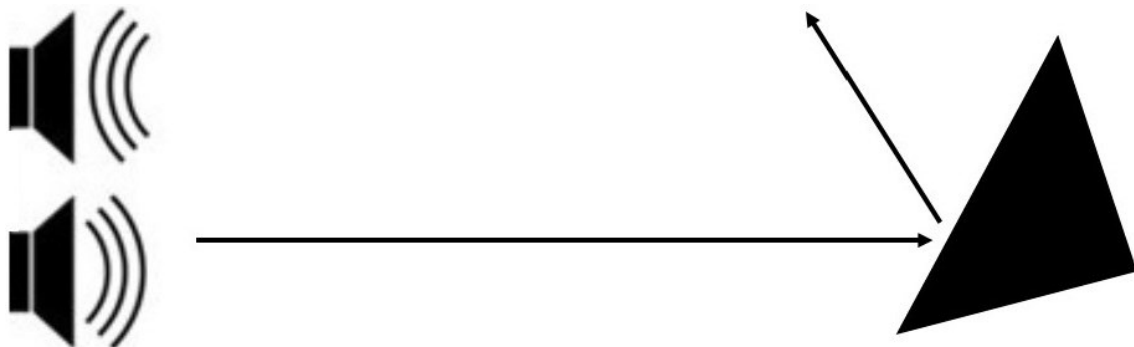
Abbildung 2.1.: Gebündelte und gerichtete Reflexion von Ultraschall an einem Objekt
