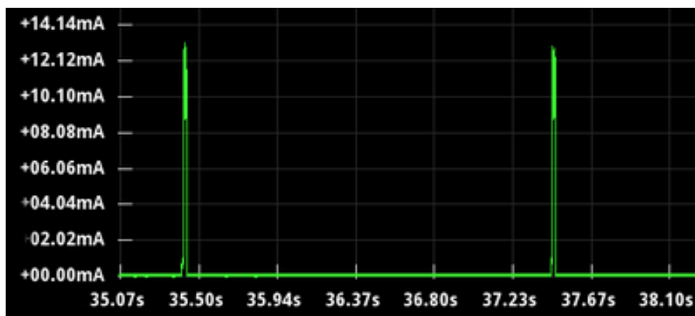
Abbildung 4.18.: Duty-Cycling mit RTC als Wakeup-Trigger
