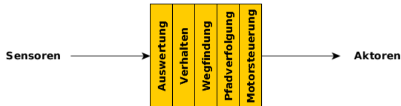
Abbildung 4.2: Klassische Robotersteuerungssystem-Architektur ohne Subsumption [3].
