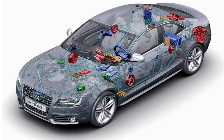
Abbildung 1.2: Aufbau der ICT mit verteilten und vernetzten ECUs in einem modernen Fahrzeug. (Quelle: http://autoservice-haensel.de/elektrik-elektronik.html )
