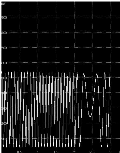
Abbildung 4-26: Gute Ausrichtung des Interferometers ([mV] über [s])
