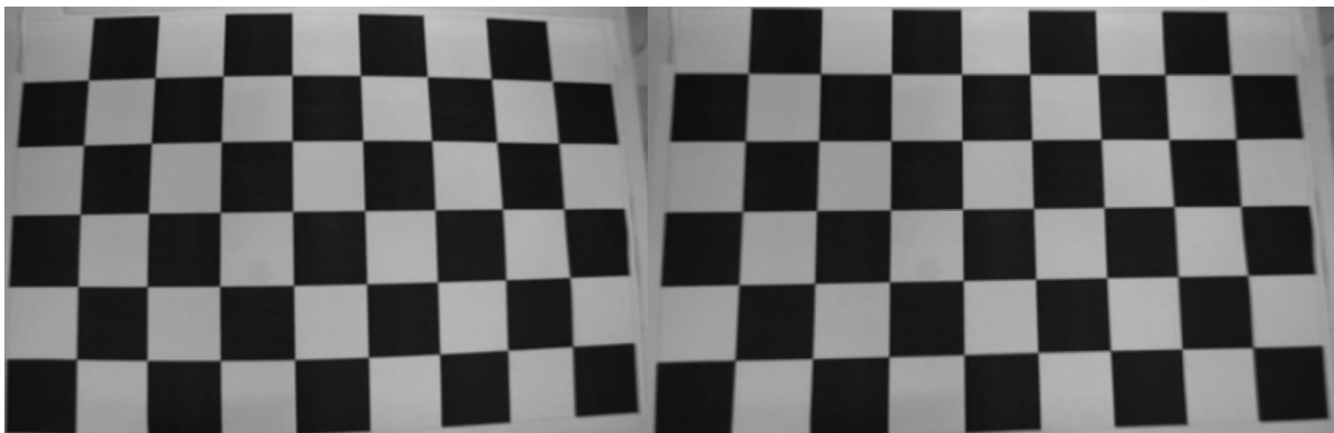
Abbildung 3: Beispiel für eine Bild-Entzerrung (links Originalaufnahme, rechts entzerrtes Bild)
