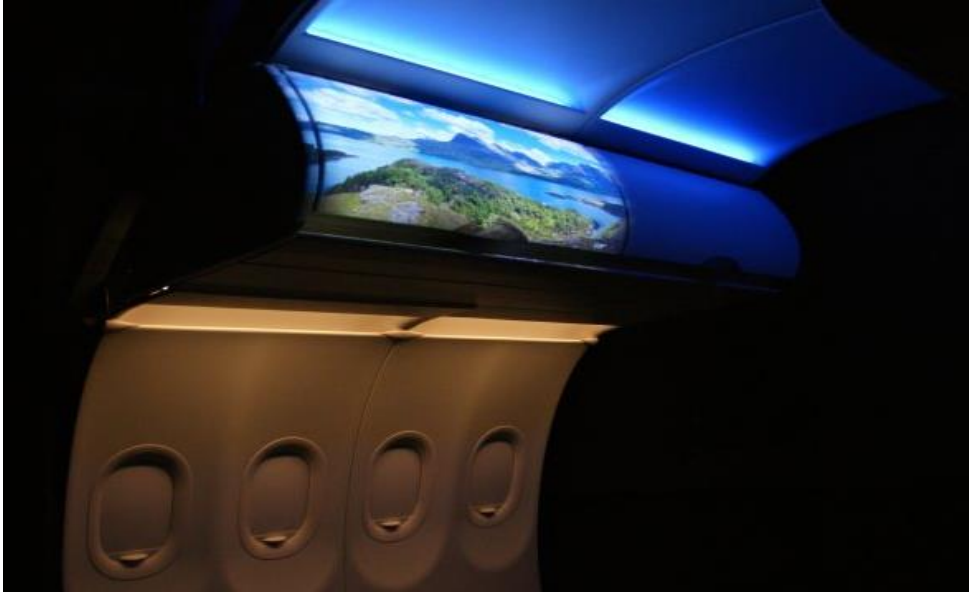
Abbildung 4: Dandelion-Projektionskonzept der Firma DIEHL Aerosystems 50
