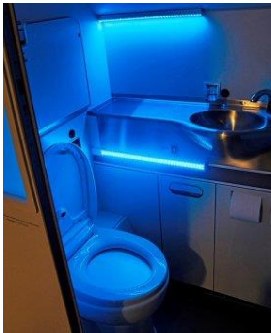
Abbildung 5: Waschraum mit Selbstreinigungsoption durch UV-Licht der Firma Boeing 51
