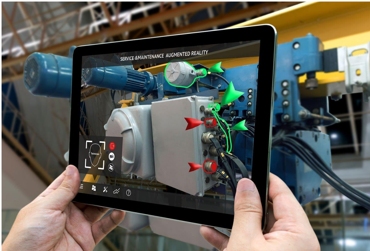
Abbildung 6: Einsatz von AR zur Unterstützung einer Systemwartung 58
