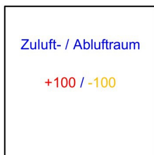
Abbildung 4: Raum mit Zu- und Abluftversorgung
