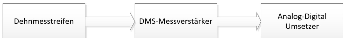
Abbildung 18: Messkette der Dehnmessstreifen-Messeinrichtung
