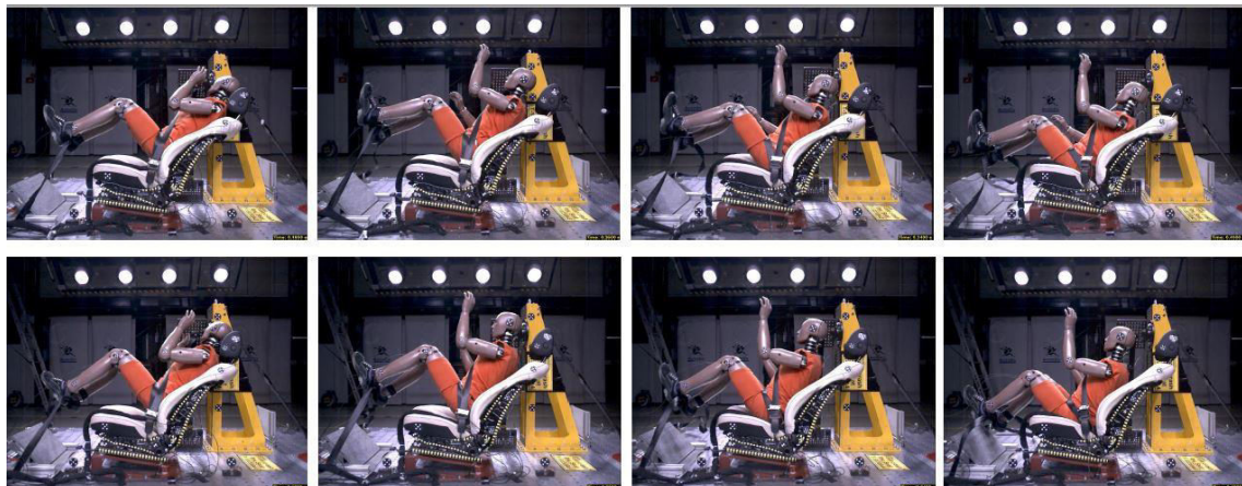
Abbildung C.2-2: Kinematik des Dummys nach dem Rebound bei 180, 260, 340 und 400 ms bei Standard Lehnenneigung (oben) und geänderter Lehnenneigung (unten)
