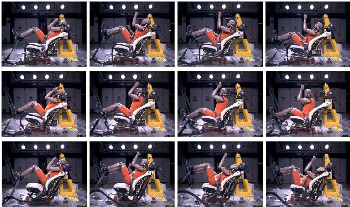
Abbildung 5: Kinematik des Dummys nach dem Rebound bei 180, 260, 340 und 400 ms mit unterschiedlichen Gurtsystemen, Testserie 1
