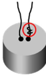
**Abbildung 26: Verbindung Zusatzgewicht Nylonfaden. Der Nylonfaden wird in der Nähe der Verbindung verknotet, so dass der Spannvorgang durch diese nicht beeinträchtigt werden kann.**
