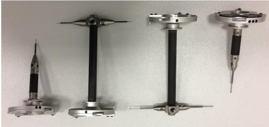
**Abbildung 17: Auswahl an Tastersystemen für die Prüfung von dünnwandigen Drehteilen mit Abmessungen im Bereich weniger Millimeter auf einem KMG. Es kommen hauptsächlich Taster  $\varnothing 0,3$  mm (beide links) und  $\varnothing 0,6$  mm (beide rechts) zum Einsatz. [7]**
