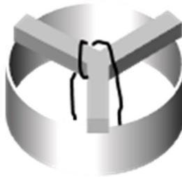
**Abbildung 27: Verbindung Nylonfaden Spannkreuz. Das Spannkreuz mit drei Armen zentriert den Nylonfaden nicht optimal.**
