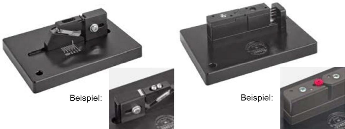
**Abbildung 11: Mikro-Fixiereinrichtung vom Hersteller *dk Fixiersysteme GmbH & Co. KG*. Die Spannkraft kann einerseits über eine schiefe Ebene erzeugt werden (links) und durch die Zugabe von kleinen Gewichtskugeln verändert werden (linkes Beispiel). Andererseits bringen mehrere Mikrofedern eine einstellbare Fixierkraft auf (rechts). [11, S. 216]**
