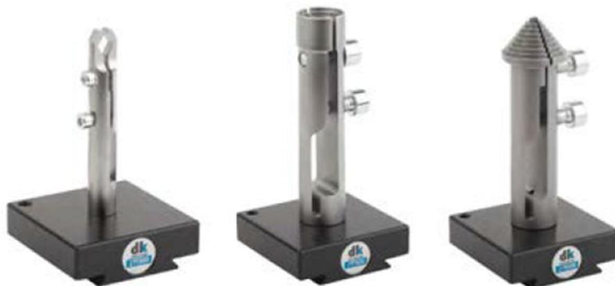
**Abbildung 10: Ausgewählte Kleinteilespanner vom Hersteller *dk Fixiersysteme GmbH & Co. KG* für rotationssymmetrische Bauteile. Die Ausführung unterteilt sich in Horizontalprisma (links), Außenklemmung (Mitte) und Innenklemmung (rechts). Die Vorteile der beiden rechten Varianten sind die formerhaltenden Spannbacken, die die Flächenpressung minimieren. Die Betätigung erfolgt durch Schraubendrehung per Handkraft. [11, S. 97 ff]**
