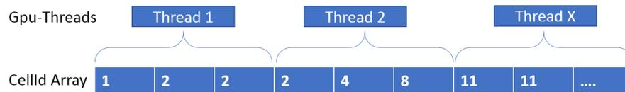
Abbildung 5.2: Beispiel für das Erstellen der Kollisionssublisten auf der GPU
