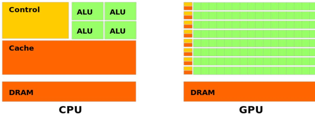
Abbildung 2.1: Architekturvergleich zwischen GPU und CPU [32]. Links die CPU mit vier Kernen(ALUs), großen Cache und großer Kontrolleinheit. Rechts die GPU, die mit einem zentralem DRAM und mehreren Arbeitsgruppen (Compute Units) bestehend aus jeweils einer Kontrolleinheit einem Cache und mehreren ALUs
