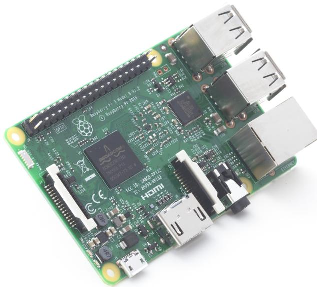
Abbildung 2.5.: Raspberry Pi 3 Model B [26]
