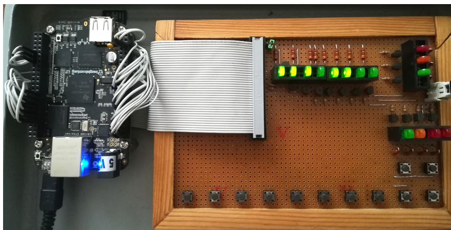
Abbildung 8.1.: Testboard für die Überprüfung von Sensorik und Aktorik
