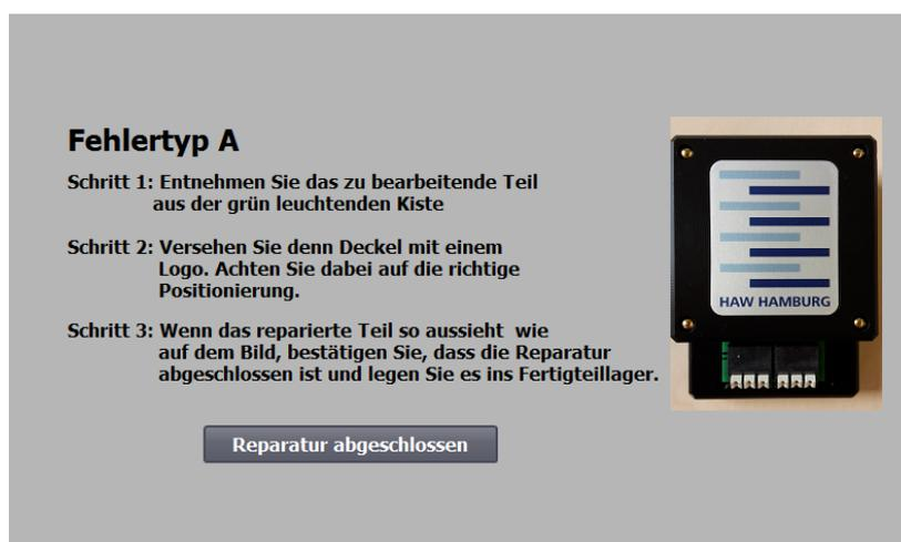
Abbildung 6.7.: Anleitung für die Reparatur eines Fehlteils der Kategorie A
