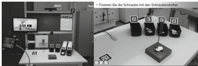
Abbildung 2.15.: Aufbau der Montagestation (links) und Anzeige der virtuellen Anweisung (rechts), Quelle: [4, S.536]
