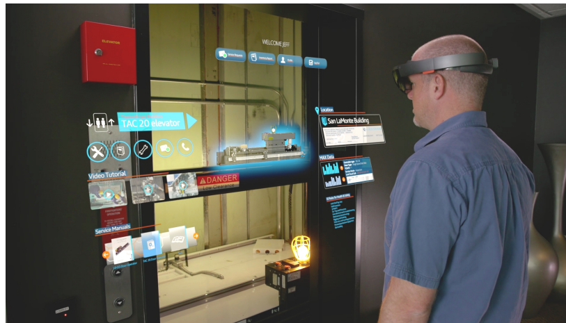
Abbildung 3.3: Wartung eines Aufzugs mit Hilfe der HoloLens ((vgl. Ridder, 2016 ))
