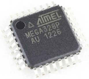
Abbildung 2.7.: Beispielhafter Mikrocontroller Atmel Mega328P
