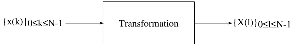
Abbildung 2.4: Diskrete Transformation der Signalfolge x(k) in die Spektralfolge X(l)
