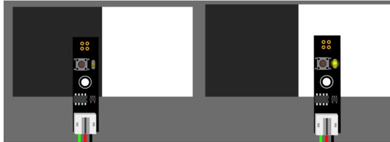
Abbildung 4: Erkennung der Oberflächenfarbe durch Line-Tracking-Sensoren<sup>5</sup>
