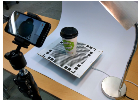
Abb. 4.16: Endgültiger Aufbau der Scan-Umgebung mit Qlone (Quelle: Eigene Arbeit)
