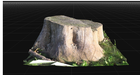
Abb. 2.6: Einseitige (“ingebrannte”) Schatten als Konsequenz ungleichmäßiger Beleuchtung (Quelle: Eigene Arbeit)
