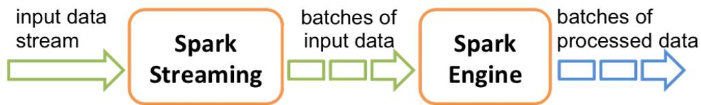
Abbildung 3.3.: Streaming Modell in Spark (Quelle: [Spark \(2018b\)](#))
