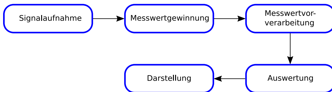
Abbildung 3.5: Schematischer Arbeitsablauf, der von einer Signalverarbeitung und Bedienoberfläche umgesetzt werden muss.
