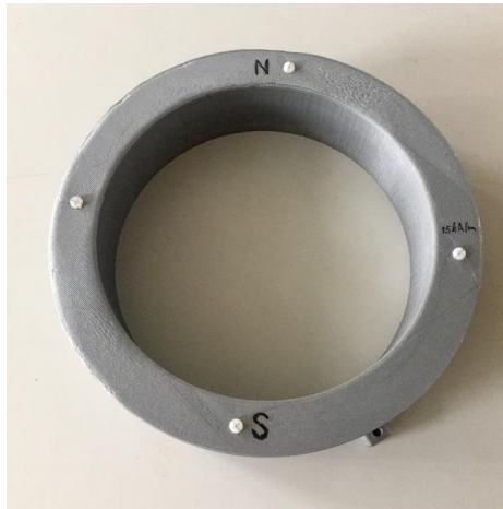
Abbildung 6: 15kA/m Halbacharray zur Kalibrierung
