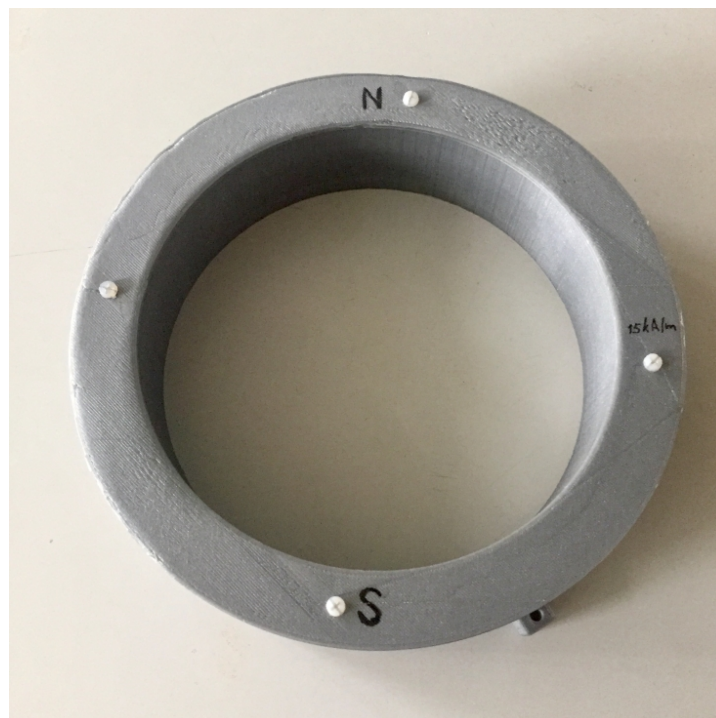
Abbildung D.7: 15kA/m Halbacharray zum durchführen der Langzeitmessung.
