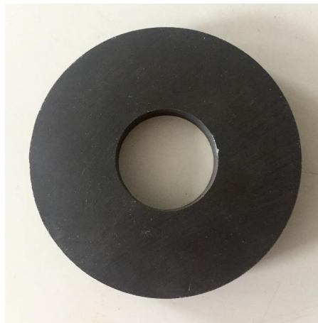
Abbildung 7: Quadrupol zur "one-shot" Kalibrierung
