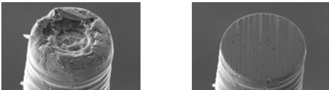
Abbildung 2-16: Spitze des Probenpins vor (links) und nach (rechts) der FIB-Ebnung. [9]
