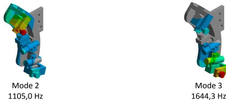
Abbildung 4-56: Moden für Gelenk (I) und (II) unter Vorspannung mit Kontakt.
