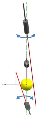
Abbildung 4-3: Benötigte Rotation der Interferometerachsen (I) und (III).
