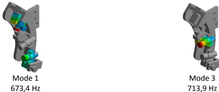
Abbildung 4-55: Moden für Gelenk (I) und (II) bei Vorspannung ohne Kontakt.
